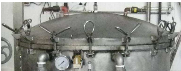
Tximeleta-azkoinen sistemaren bidezko itxiera baten xehetasuna
