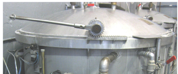
Kremlera-piñoiaren sistemaren bidezko itxiera baten xehetasuna
