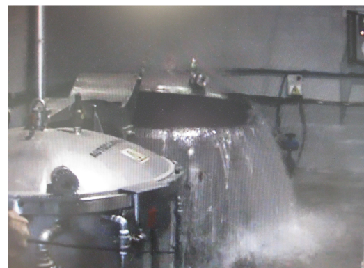
Ur beroa kanpora ateratzen autoklabe bertikal batean. "Txirla efektua"
