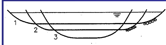
Forma de la sección transversal con material grueso (1), medio (2) y fino (3)
