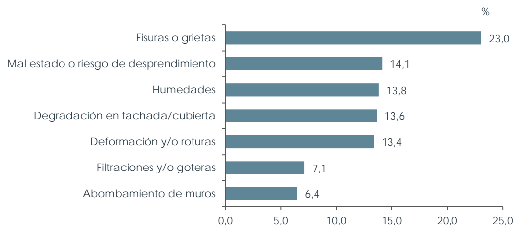
Gráfico 4.16 Principales deficiencias de los edificios calificados como “no aptos” en los IEE realizados en Navarra
