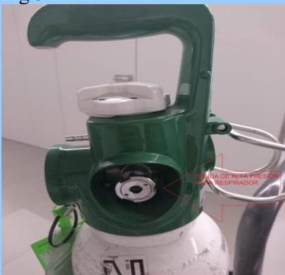
Fig.5. Salida de alta presión
