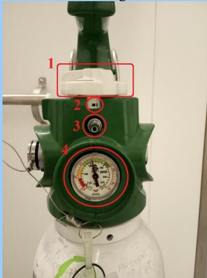
Fig.12. 1.Rueda reguladora de caudal/flujo. 2-Indicador de caudal/flujo. 3-Toma de oxígeno bala. 4-Manómetro indicador de presión.
